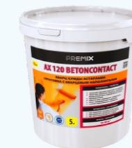
Предназначена для обработки гладких слабо впитывающих оснований стен из монолитного или сборного железобетона перед нанесением плиточных клеев, цементных и гипсовых штукатурок. В состав грунтовки входит мелкий кварцевый песок, придающий шероховатость обработанной поверхности, благодаря чему обеспечивается высокая адгезия отделочных материалов к гладким основаниям.
